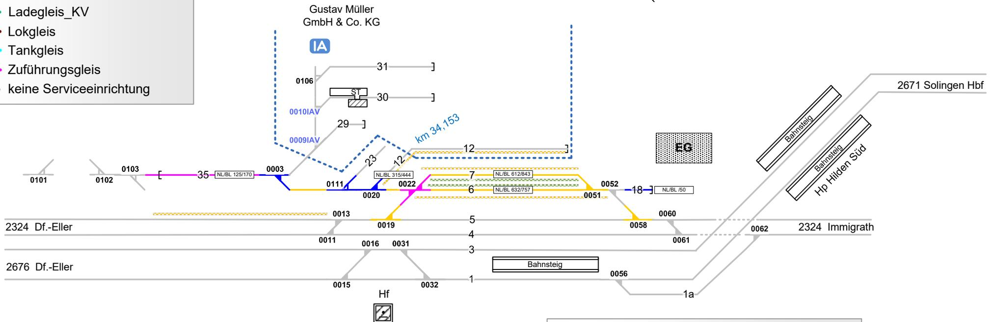
Nutzungsart der Gleiszwischenräume (Wege) ist Geschwindigkeitsabhängig. Ausweisung erfolgt gemäß aktuellen, betrieblichen Vorgaben zur Geschwindigkeit. Pro Zwischenraum werden 2 Wegearten ausgewiesen, abhängig vom betrachteten Arbeitsgleis (V = 0 km/h) und dem benachbarten Verkehrsgleis (V > 0 km/h)
