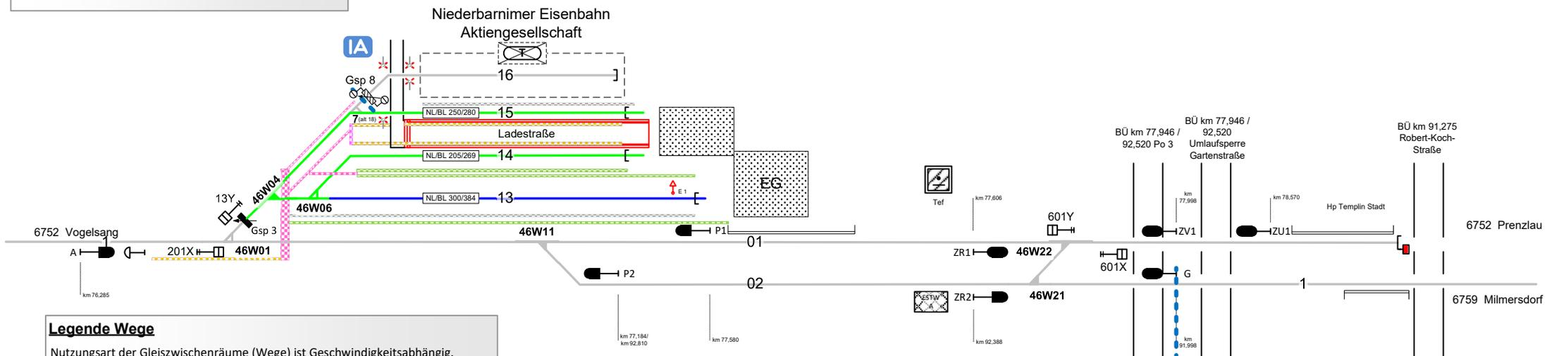
Nutzungsart der Gleiszwischenräume (Wege) ist Geschwindigkeitsabhängig. Ausweisung erfolgt gemäß aktuellen, betrieblichen Vorgaben zur Geschwindigkeit. Pro Zwischenraum werden 2 Wegearten ausgewiesen, abhängig vom betrachteten Arbeitsgleis (V = 0 km/h) und dem benachbarten Verkehrsgleis (V > 0 km/h)
