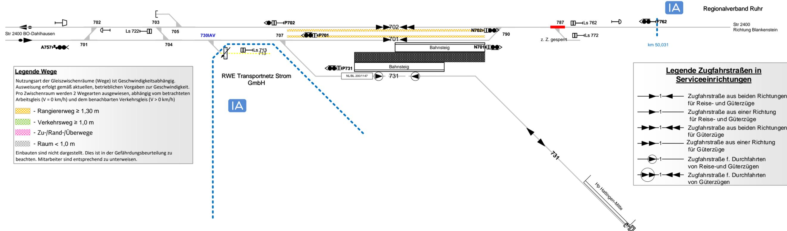
Nutzungsart der Gleiszwischenräume (Wege) ist Geschwindigkeitsabhängig. Ausweisung erfolgt gemäß aktuellen, betrieblichen Vorgaben zur Geschwindigkeit. Pro Zwischenraum werden 2 Wegearten ausgewiesen, abhängig vom betrachteten Arbeitsgleis (V = 0 km/h) und dem benachbarten Verkehrsgleis (V > 0 km/h)
